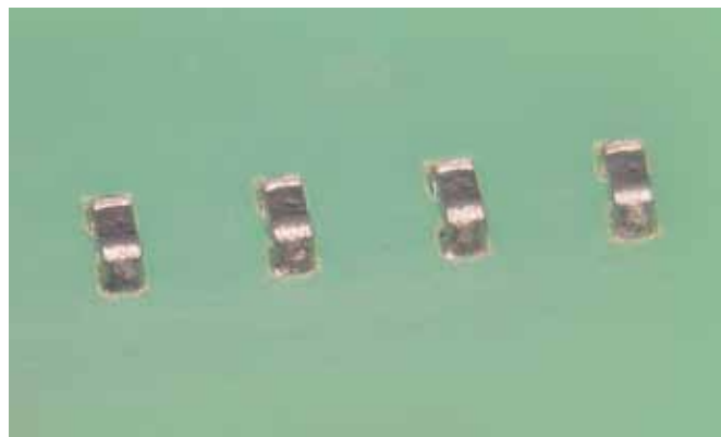
Mikrochip Baugröße 0201, welcher mit der Almit-Lötpaste NH-GE gelötet wurde; flacher Benetzungswinkel, Graping minimiert
