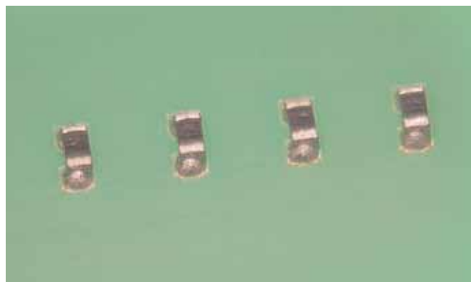
Mikrochip Baugröße 0201, welcher mit einer herkömmlichen Paste gelötet wurde; negativer Benetzungswinkel, gravierende Grapingprobleme
