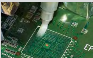
4. Auftragen von Flussmittel bzw. Lotpaste
