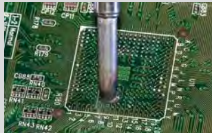
2. Entfernen von überschüssigem Lot von den Anschlussflächen auf der Platine
