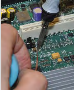
Entlöten mit Entlötlitze
