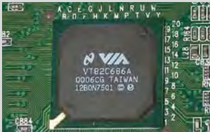
1. Ball-Grid-Array-Chipgehäuse (BGA) zunächst entlöten
