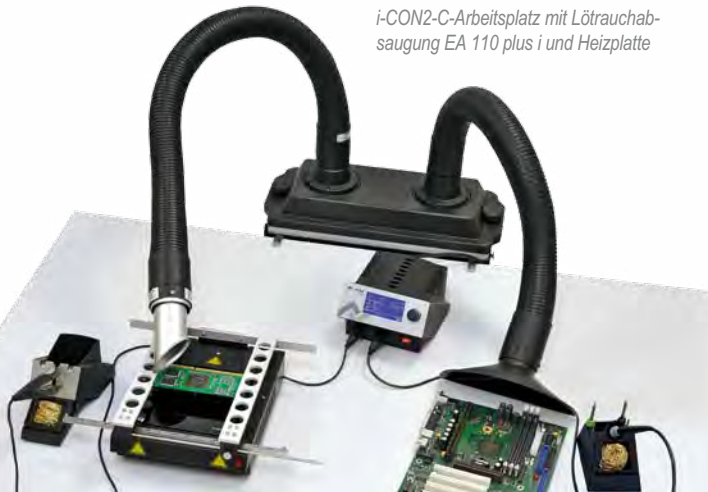
Entlöten massereicher bedrahteter Bauteile mit dem X-TOOL
