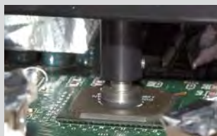
5. Platzieren des neuen Bauteils
