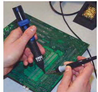
Absaugen des erhitzten Restlotes mit einer mechanischen Entlötpumpe
